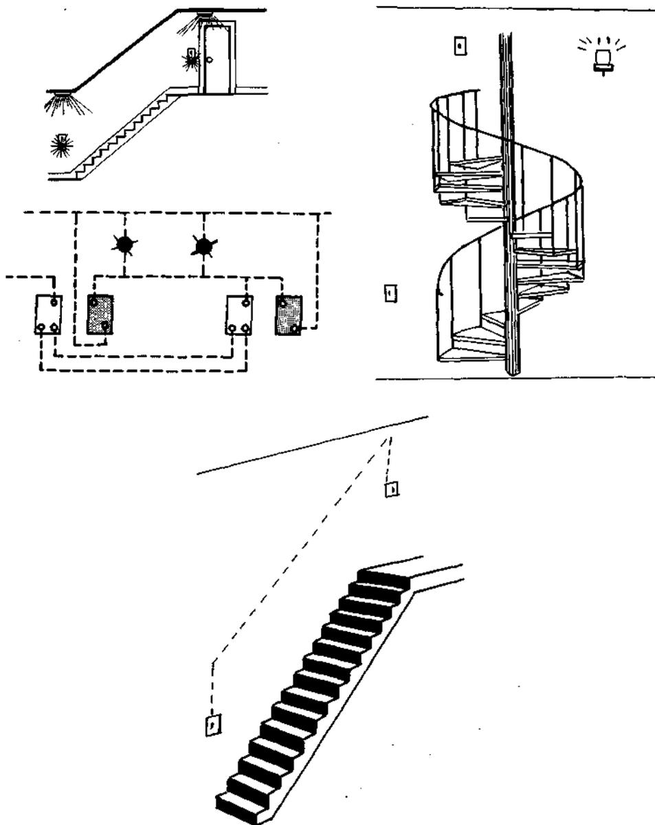
Figura 2.29 Ejemplos de aplicación de apagadores de 3 vías
