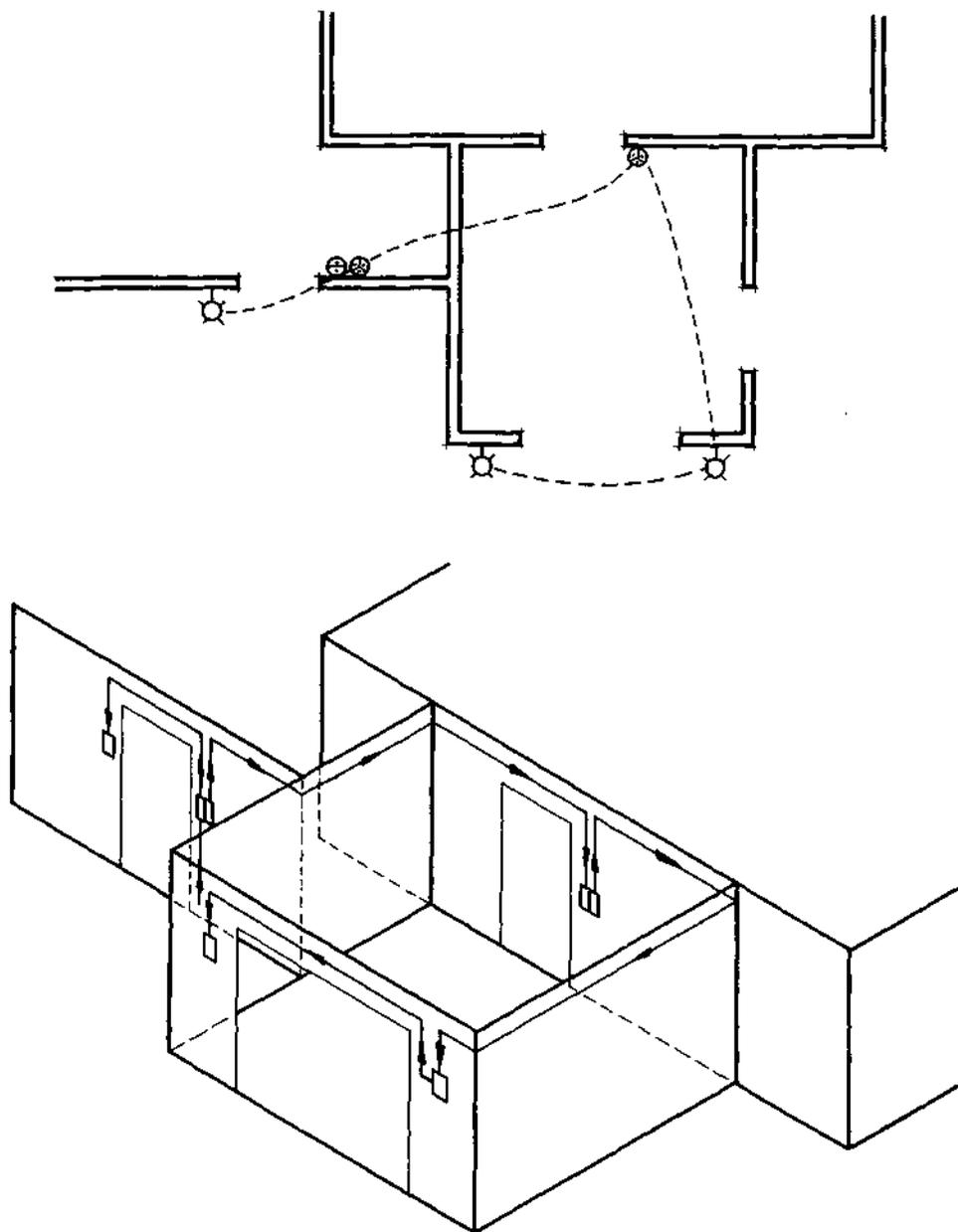
Figura 3.10. Alumbrado exterior controlado desde el interior.
