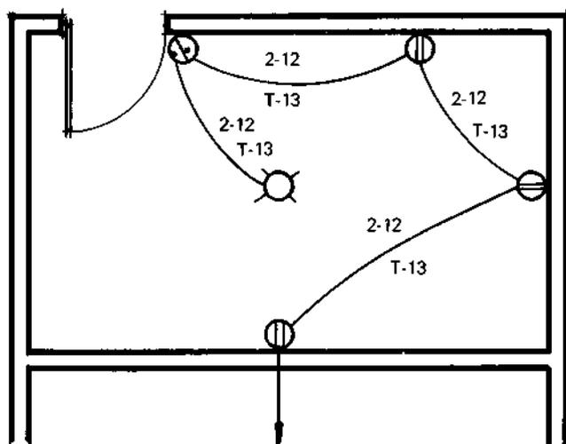
T-13 significa tubo conduit de 13 mm de diámetro.
