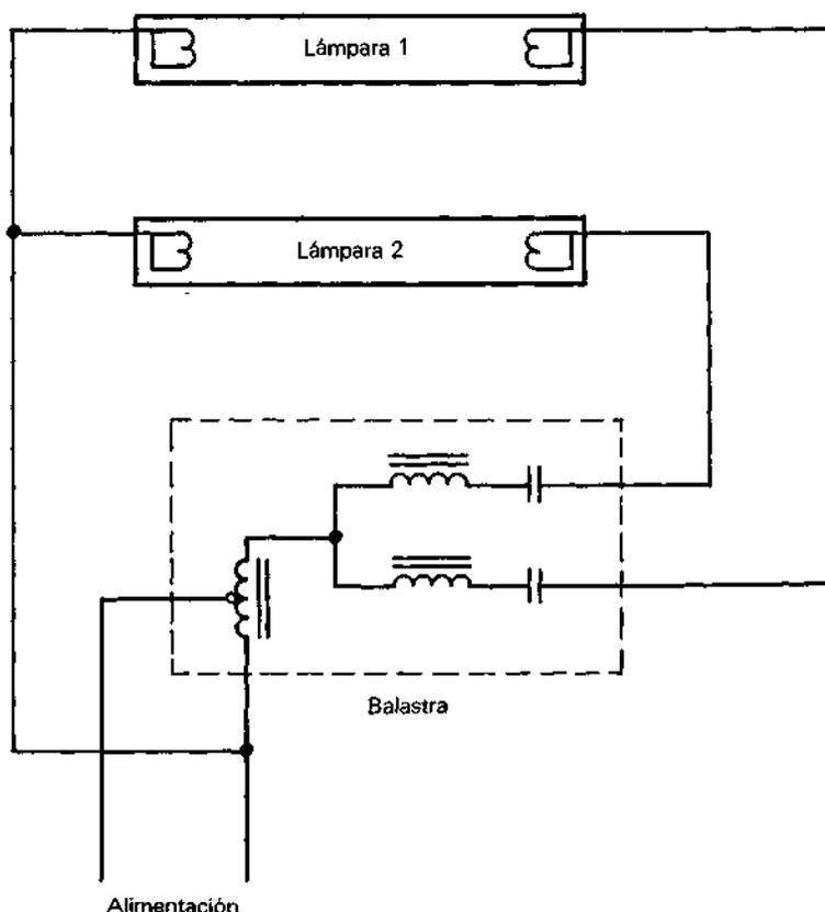
Figura 3.21 Arreglo de lámparas con arranque instantáneo
