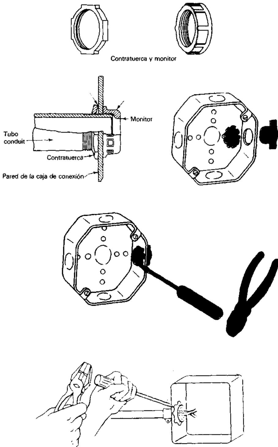
Figura 2.21 Técnica de montaje de contratuercas y monitores.
