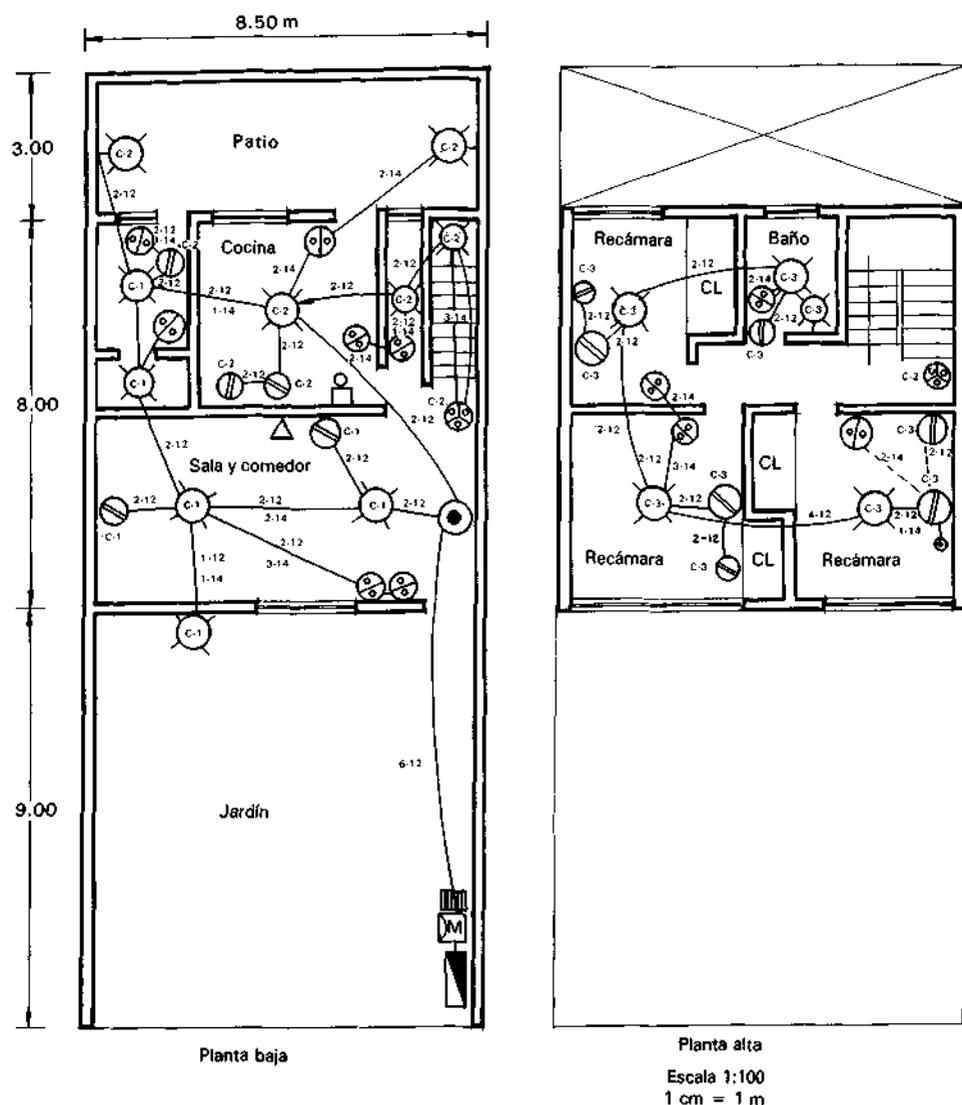
Figura 4.13 Instalación eléctrica de una casa habitación
