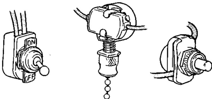
Figura 2.26 Apagadores sencillos de palanca, cadena y botón
