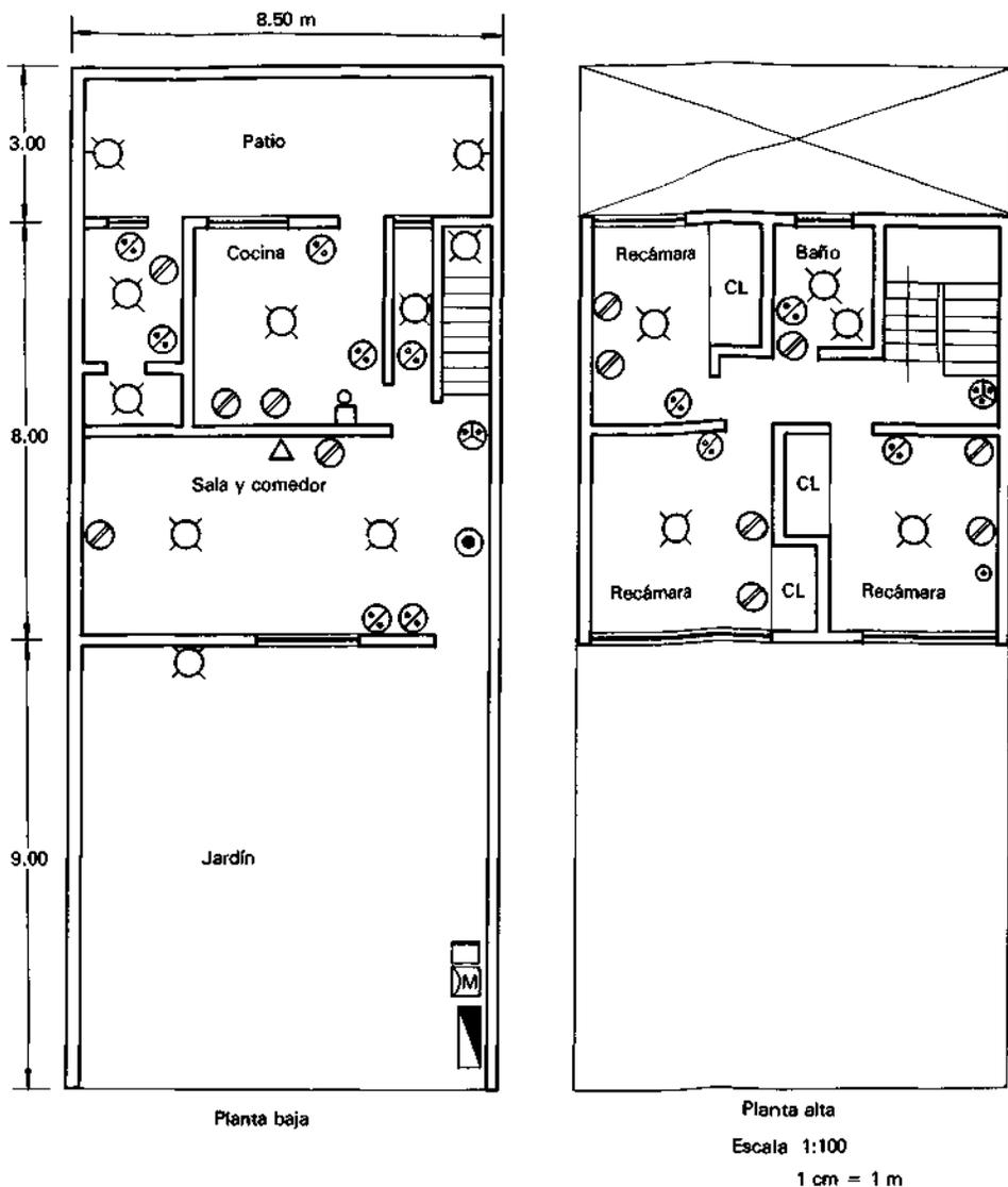
**Figura 4.14** Instalación eléctrica de una casa habitación
