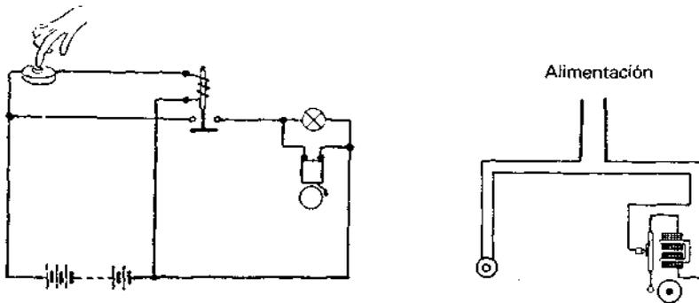
**Figura 3.30** Esquema básico de un sistema de alarma
