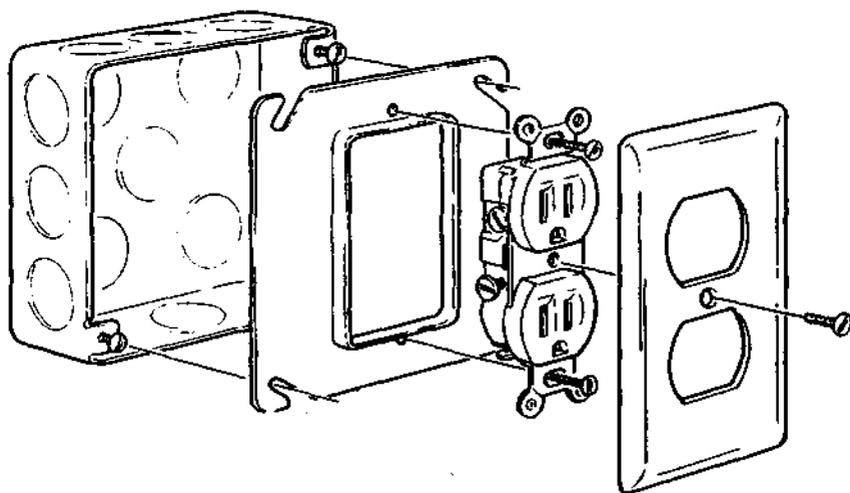
**Figura 2.32** Contacto doble y montaje en caja cuadrada
