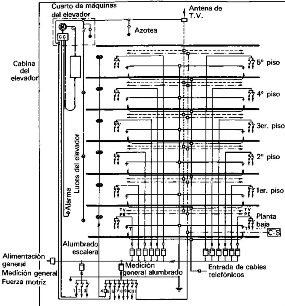
Plano de instalación eléctrica de alumbrado y elevador así como T.V. y Tel. en un edificio de 5 pisos y 2 departamentos por piso.
