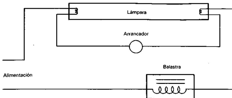
Figura 3.19 Lámpara con alto factor.
