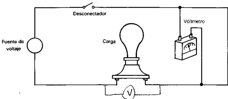
Figura 1.8 Conexión de un vóltmetro
