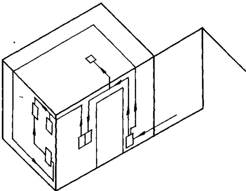
Figura 3.7. Alambado de un baño.
