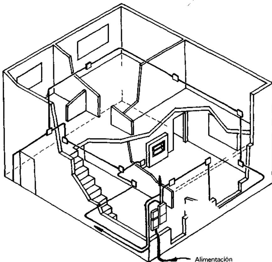
Las trayectorias dan una idea del recorrido de la tubería y alumbrado.
