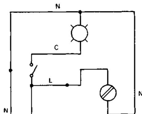
**Figura 3.16 c)** Variante de conexión para 1 contacto doble.
