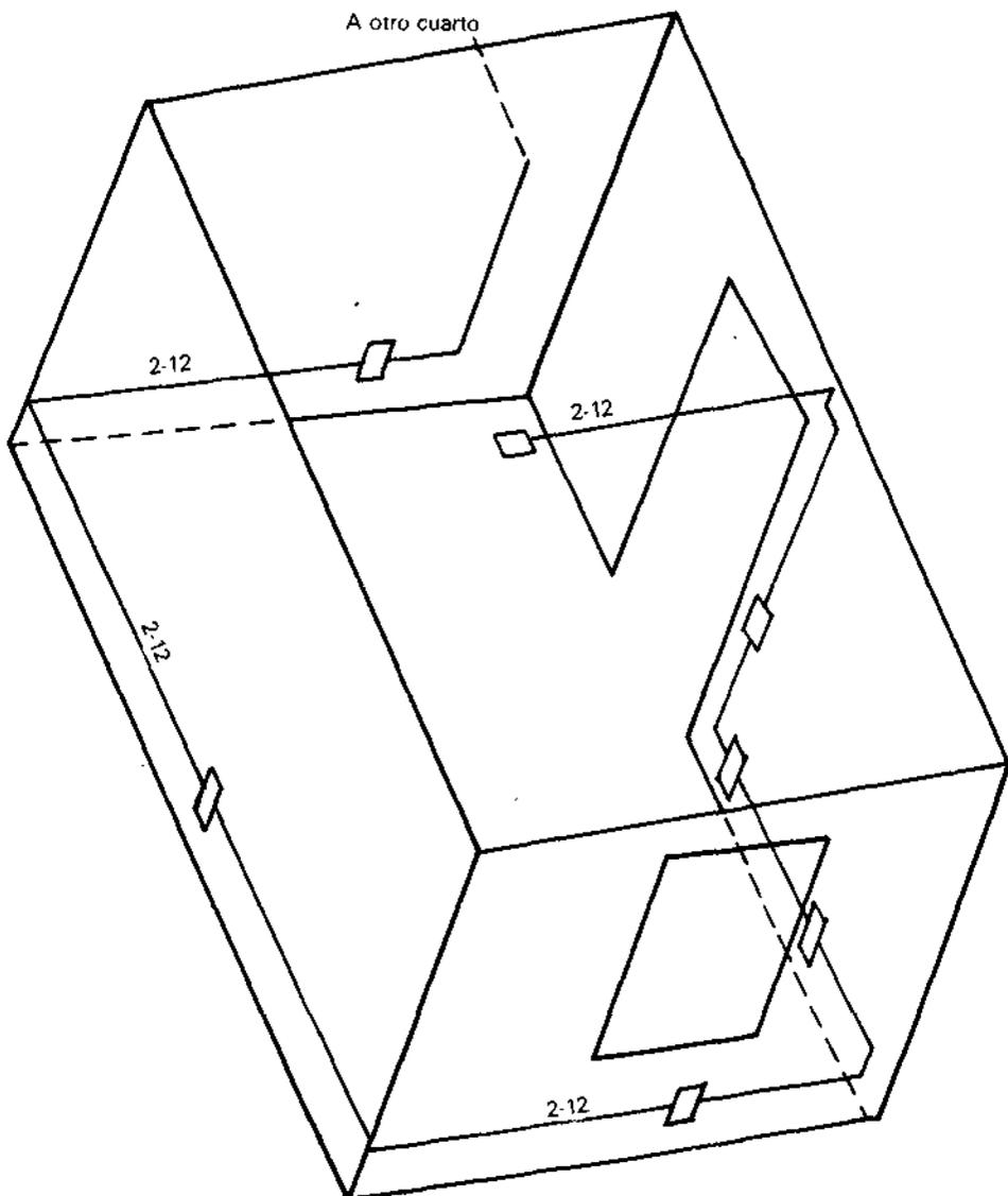
**Figura 4.11** Distribución de alambrado y trayectorias de tuberías.
