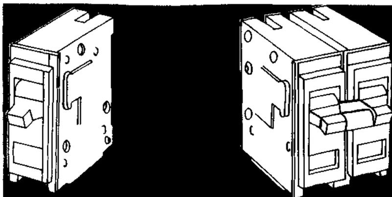
Figura 2.45 Interruptor termomagnético
