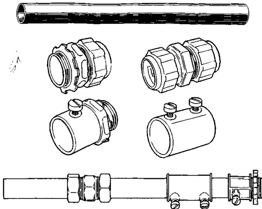
Figura 2.15 Tubo conduit de pared delgada y uniones
