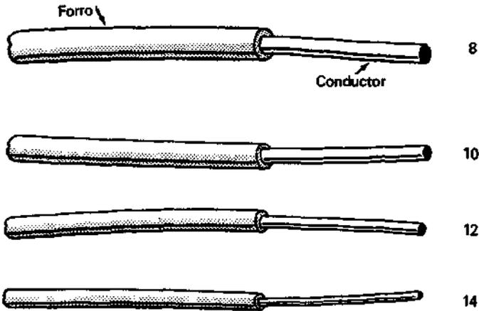
Figura 2.3 Conductores de un solo alambre forrados.
